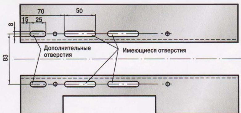
Рис. 2. Крепление электродвигателя на «моторной» площадке культиватора.
