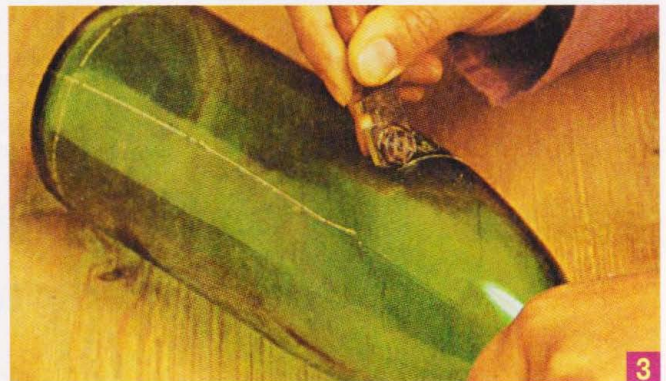
3 На пустых бутылках из-под вина с помощью стеклореза делают надрезы по периметру выше доньшка и ниже горлышка бутылки, а также вдоль. Лёгким постукиванием тыльной части стеклореза по верхнему надрезу от бутылки откалывают горлышко, а постукиванием изнутри по продольному шву бутылку разделяют на две половины. После этого из стекла можно выкроить требуемые полосы (с выполнением надрезов с внутренней стороны).
